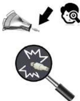
Entfernen Sie die Zündkerze mit einer Flachzange. Prüfen Sie die Keramik auf Risse.
