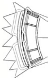
Das Drehgelenk ist mit einem Gitterfilter
